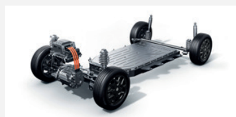
Umístění trakční baterie v podlaze vozu
